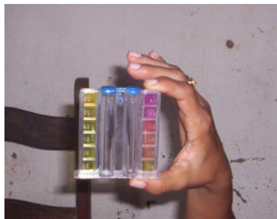
Figura 4.5 – Medição de pH e cloro das amostras imediatamente após a coleta, Araçuaí.
