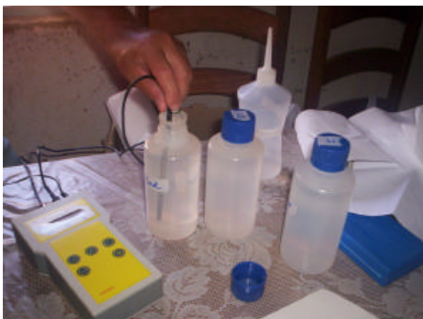
Figura 4.5 – Medição de pH e cloro das amostras imediatamente após a coleta, Araçuaí.
