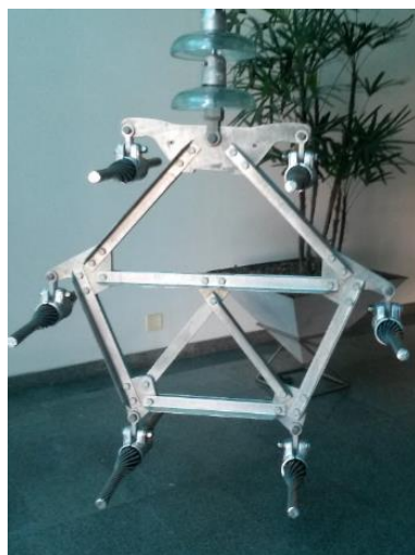
Figura 44 – Estrutura de arranjo de seis condutores com espaçador e isolador.
