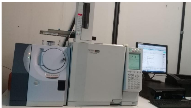
Figura 13 - Cromatógrafo a gás da marca Shimadzu, modelo GCMS-QP 2010 Plus
