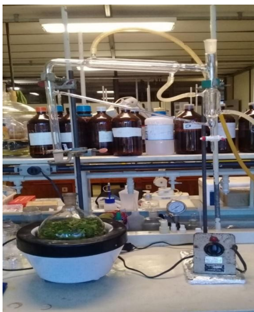
Figura 7 - Balão volumétrico acoplado ao aparelho de Clevenger sob uma manta de aquecimento para extração de óleos essenciais
