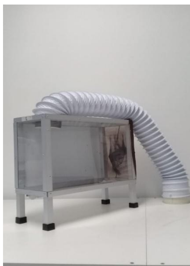
Figura 11- BG-Cage com sistema de ventilação na parte superior da gaiola
