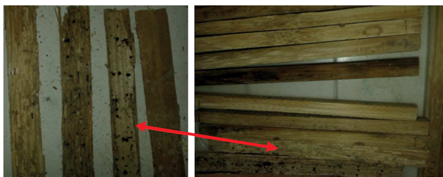
Figura 29. Bambus impregnados: imunes aos insetos.
