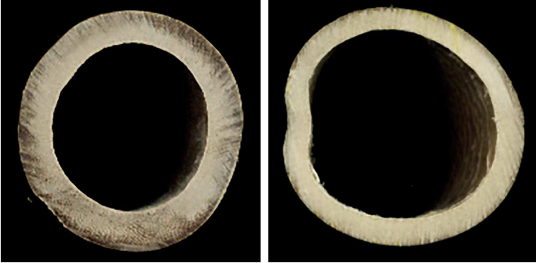
Figura 10. Seção transversal de colmos de Bambusa vulgaris : à direita, distorção nas vizinhanças do nó.
