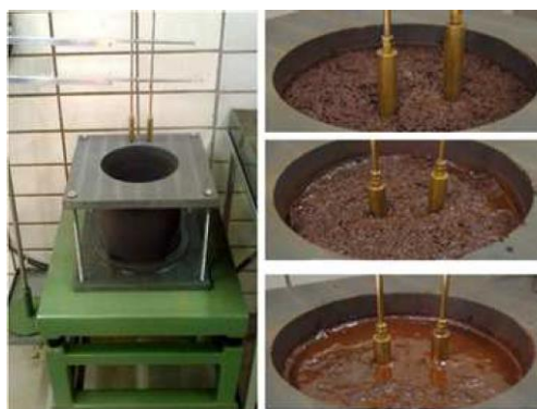
Figura 3.18 – Aparato do teste Penetration e amostras de teste com concentrado de minério.
