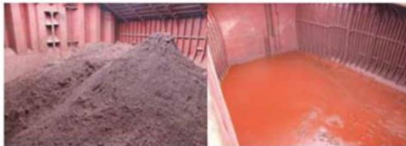
Figura 3.15 – Minério de ferro antes (esquerda) e após a liquefação (direita) em porão de um navio.
