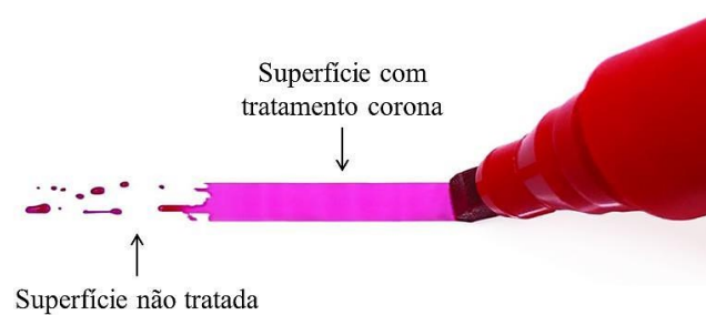
Figura 12: Efeito do tratamento corona sobre superfície polimérica.
