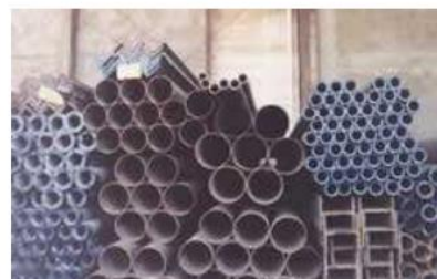
Figura 2.4 – Produtos obtidos pelo processo de laminação a quente
