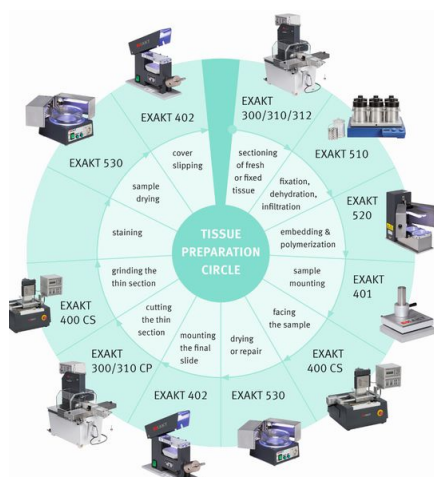
FIGURA 12: Imagem ilustrativa retirada do site do fabricante de todo o sistema Exakt (Exakt ® , Apparatebau, Norderstedt, Alemanha); demonstrando todos os estágios de confecção da lâmina histológica não descalcificada desde o procedimento de polimerização, corte, desgaste e polimento por meio dos aparelhos do experimento ( https://www.exakt.de/de/produkte/trenn- duennschliff-technik/allgemein.html ).
