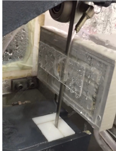
FIGURA 10: Imagem ilustrativa do momento do segundo estágio de corte através da serra de desgaste precisos sob movimento de oscilação do suporte e irrigação constante com água na serra de corte.
