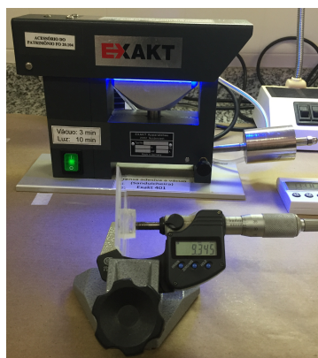
FIGURA 9: Imagem ilustrativa demonstrando a polimerização da segunda lâmina após o primeiro corte realizado. Avaliação da medida com paquímetro digital no intuito de garantir uma espessura ideal da resina aplicada em \mu\text{m} na confecção da lâmina.
