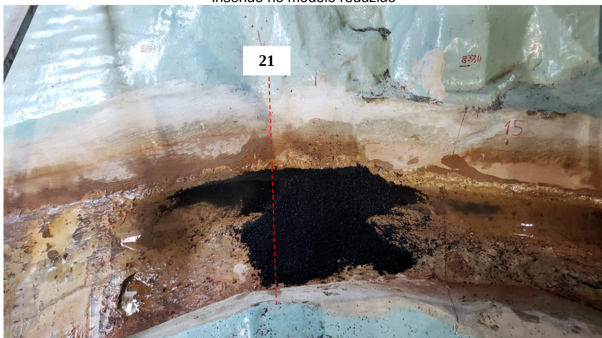
Figura 5.4 – Assoreamento próximo à seção “21”, a qual é a seção onde o sedimento era inserido no modelo reduzido
