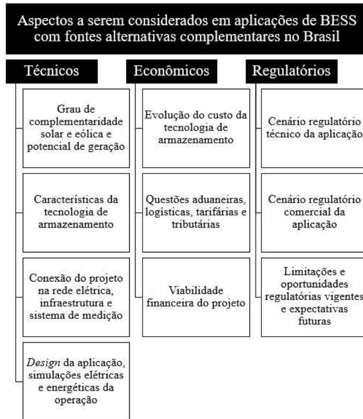
Figura 5.1. Aspectos a serem considerados em aplicações de BESS com fontes alternativas complementares no Brasil (Autora, 2023).
