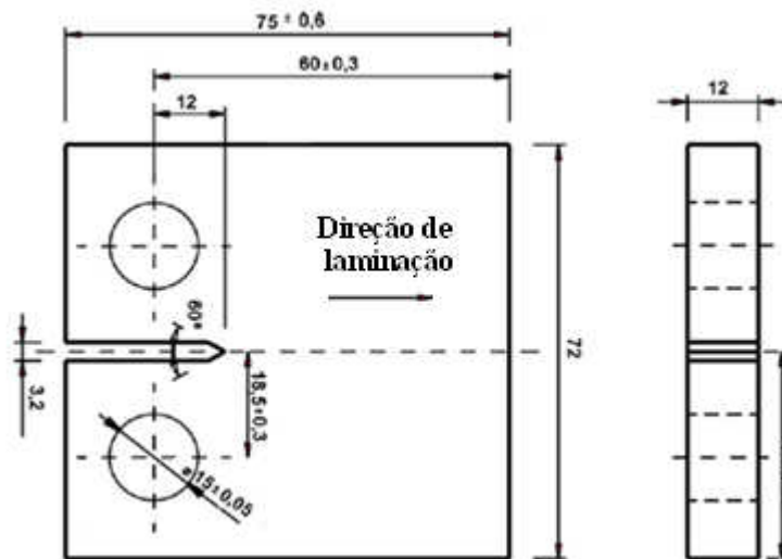
FIGURA 3.10 - Geometria do corpo de prova do compacto de tração (CT) utilizado nos ensaios de propagação de trinca por fadiga.
