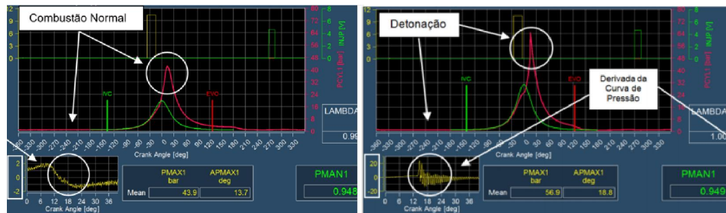
Figura 24 – a) Exemplo de análise visual da curva de pressão no cilindro em combustão normal e b) Exemplo de análise visual qualitativa da curva de pressão no cilindro com ocorrência de detonação
