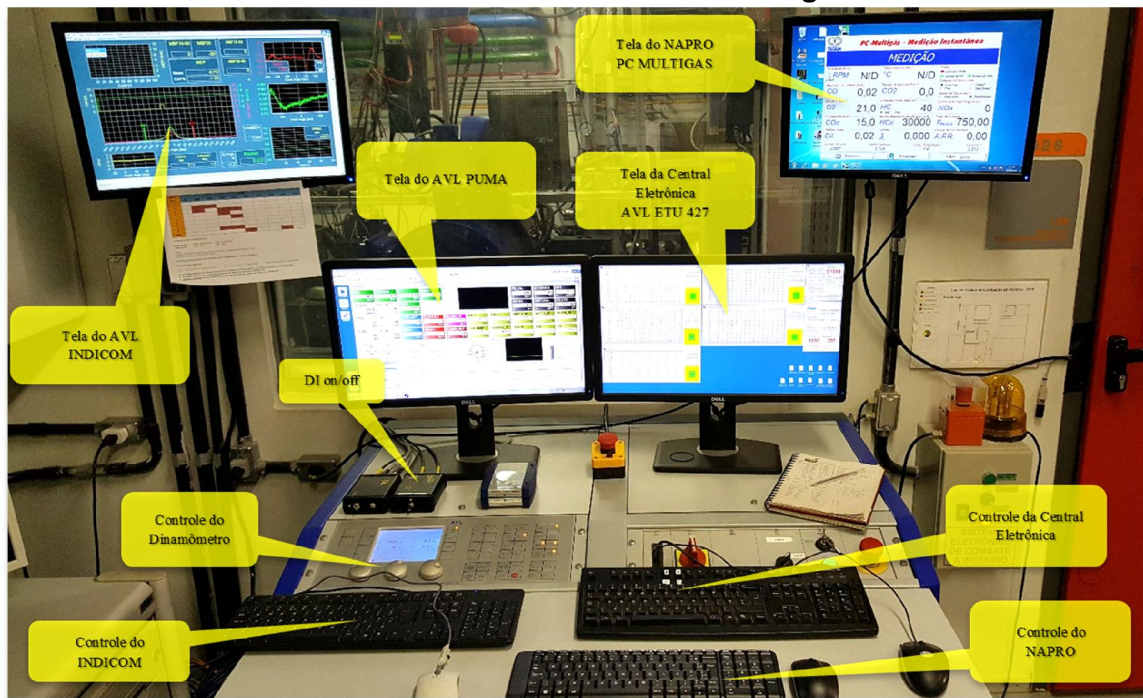
Figura 18 - Visão geral da bancada de controle do SCRE mostrando os 4 sistemas de monitoramento e controle das grandezas
