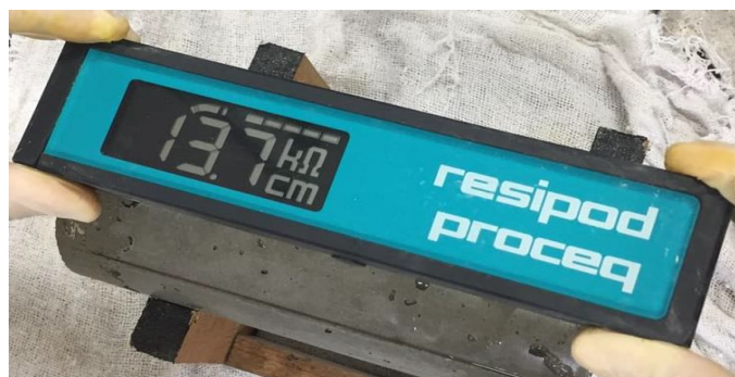
Figura 3.18 – Aparelho de resistividade elétrica superficial (Proceq, 2014).
