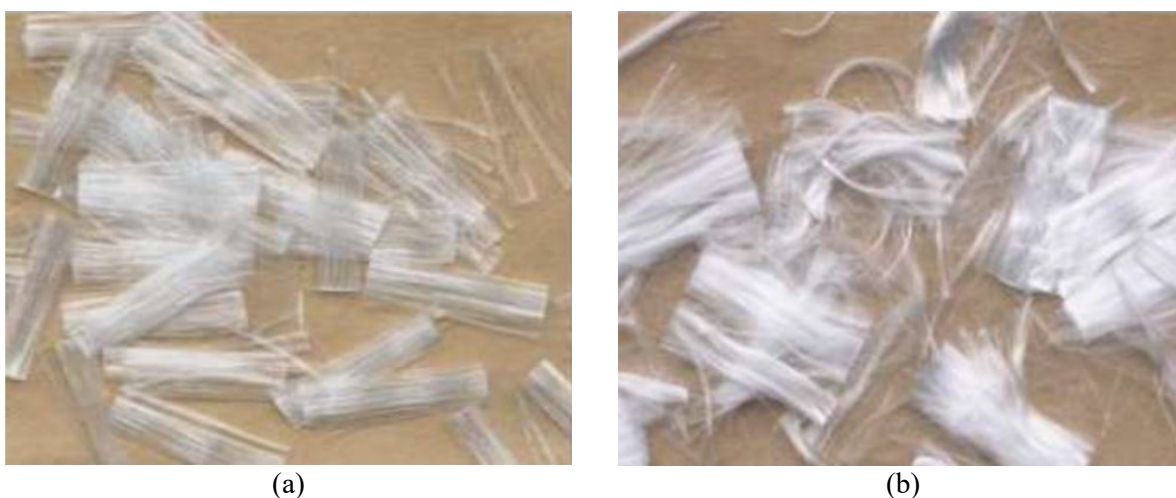
Figura 2.17 – (a) Fibras de polipropileno do tipo fibrilado (Figueiredo, 2011); (b) Fibras de polipropileno monofilamento (Figueiredo, 2011).
