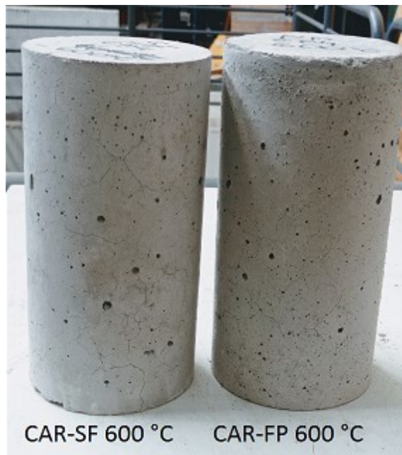
Figura 4.3– Detalhes da superfície dos corpos de provas das amostras de CAR-SF e CAR-FP após a exposição à temperatura de 600 °C.
