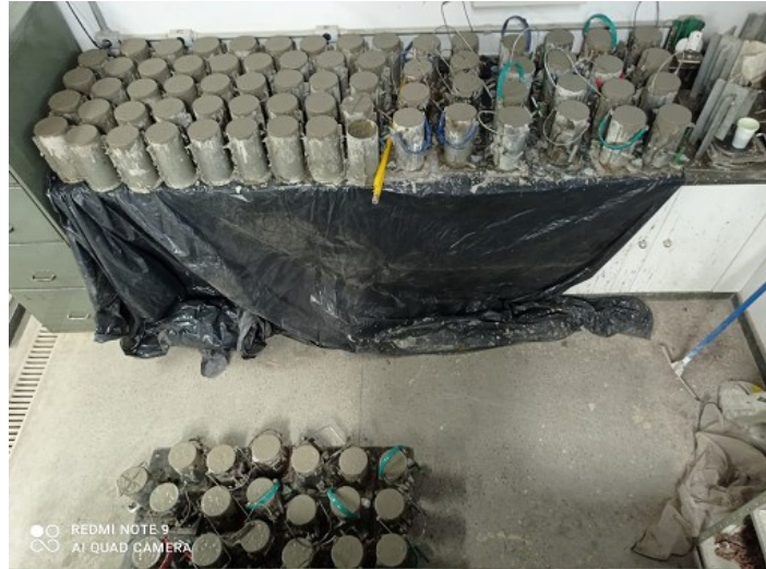
Figura 3.12 –Término da moldagem dos corpos de prova com e sem fibras de polipropileno.
