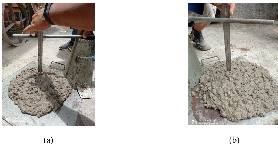
Figura 3.14 – (a) Ensaio do tronco de cone do concreto com fibras de polipropileno; (b)Ensaio do tronco de cone do concreto sem fibras de polipropileno.
