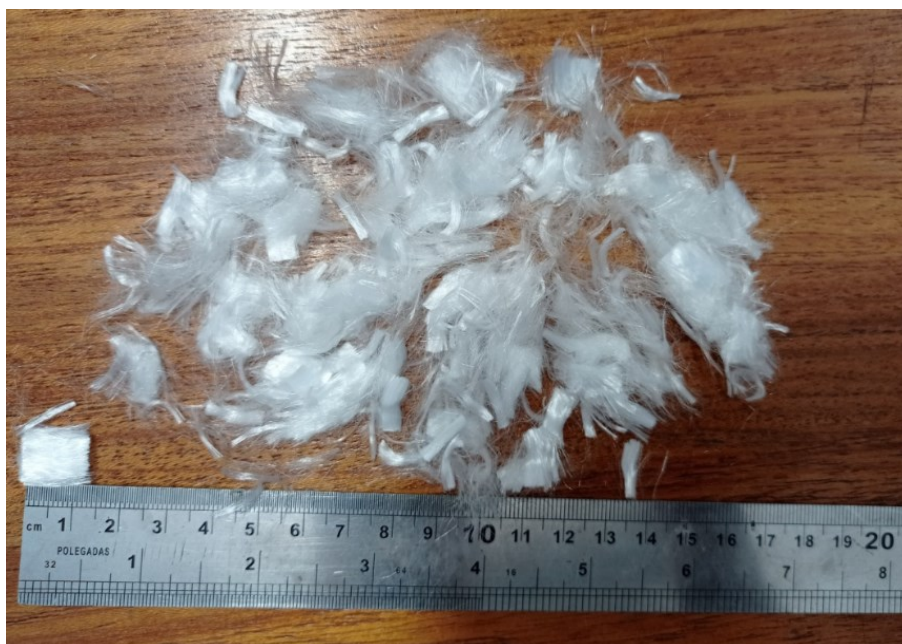
Figura 3.8 – Fibras de polipropileno tipo monofilamentos de 12 mm de comprimento e 25 µm de diâmetro fornecida pela Viapol.
