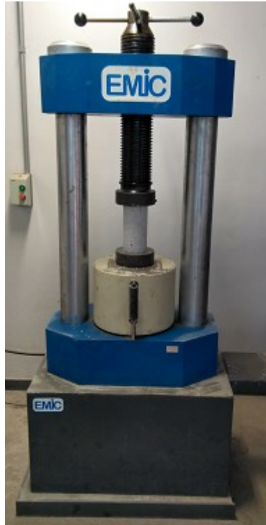
Figura 3.9 – Ensaio de compressão em corpos de provas cilíndricos de concreto.
