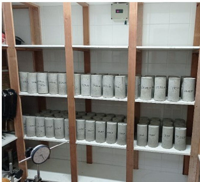
Figura 3.13 – Corpos de provas com e sem fibras de polipropileno com extremidades tratadas mecanicamente e armazenados na câmara climatizada.
