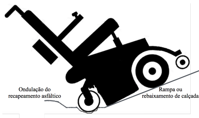
Figura 6. “Rampa perigosa”: combinação entre a elevação do asfalto recapeado, a “vala” ou a degradação causada pela drenagem da água e a inclinação inadequada da rampa de acesso ou rebaixamento de calçada inclinado de forma insegura.
