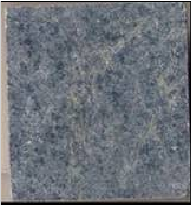
Figura VII.14: Modificações na coloração de placas de esteatito FUR antes (1) e após (2) ensaios de cristalização de sais.
