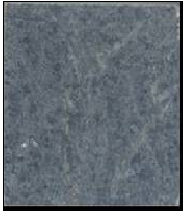
Figura VII.14: Modificações na coloração de placas de esteatito FUR antes (1) e após (2) ensaios de cristalização de sais.
