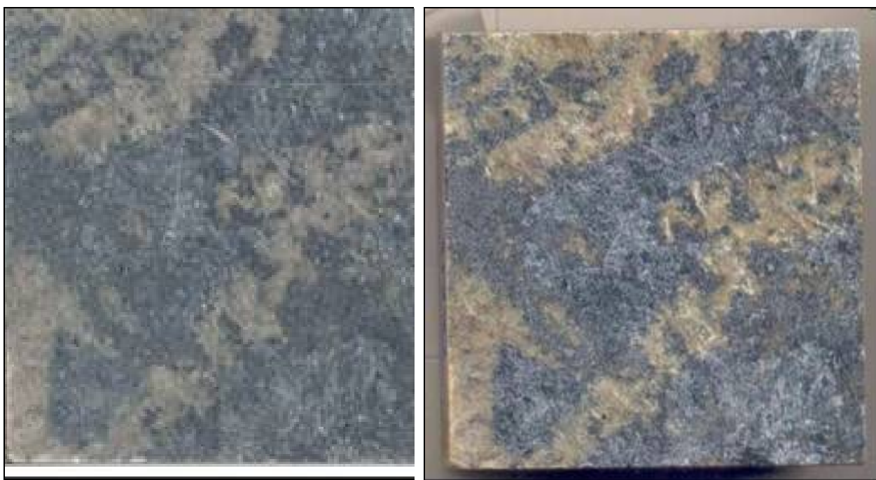
1. 2. Figura VII.13: Modificações na coloração de placas de esteatito ACA antes (1) e após (2) ensaios de cristalização de sais
