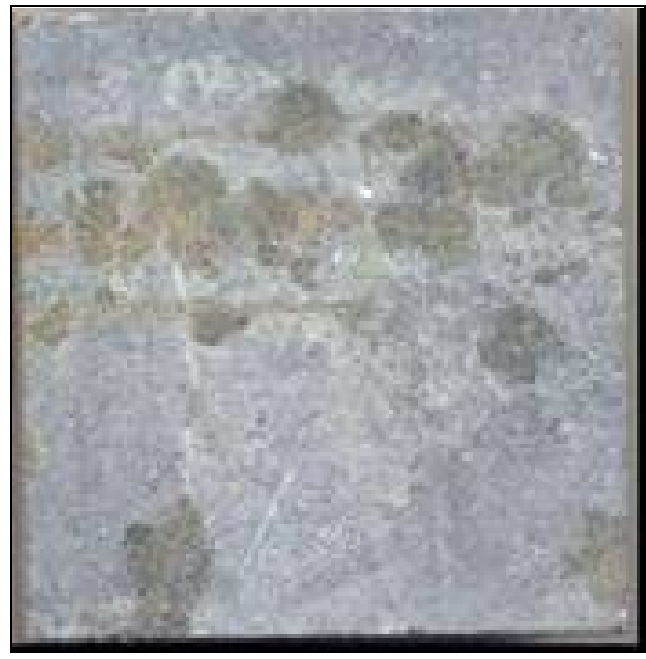
Figura VII.15: Modificações na coloração das placas de esteatito LUN antes (1) e após (2) ensaios de cristalização de sais.
