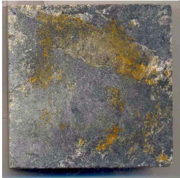
Figura VII.23: Amarelamento da placa não polida de esteatito quando exposta ao ataque com solução ácida.
