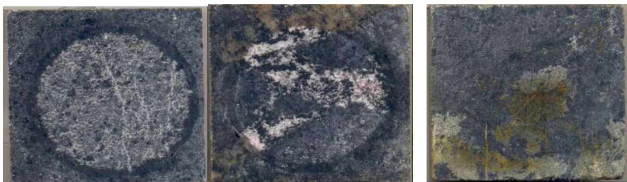
Figura VII.17: Microfissuras evidenciadas, descoloração e manchas de oxidação nos esteatitos FUR, ACA, LUN após ensaio de alterabilidade com ácido cítrico.
