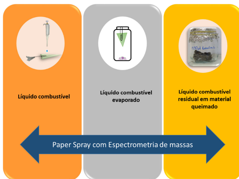
Figura 11 Diagrama dos tipos de preparo de amostras para analisar por PS-MS
