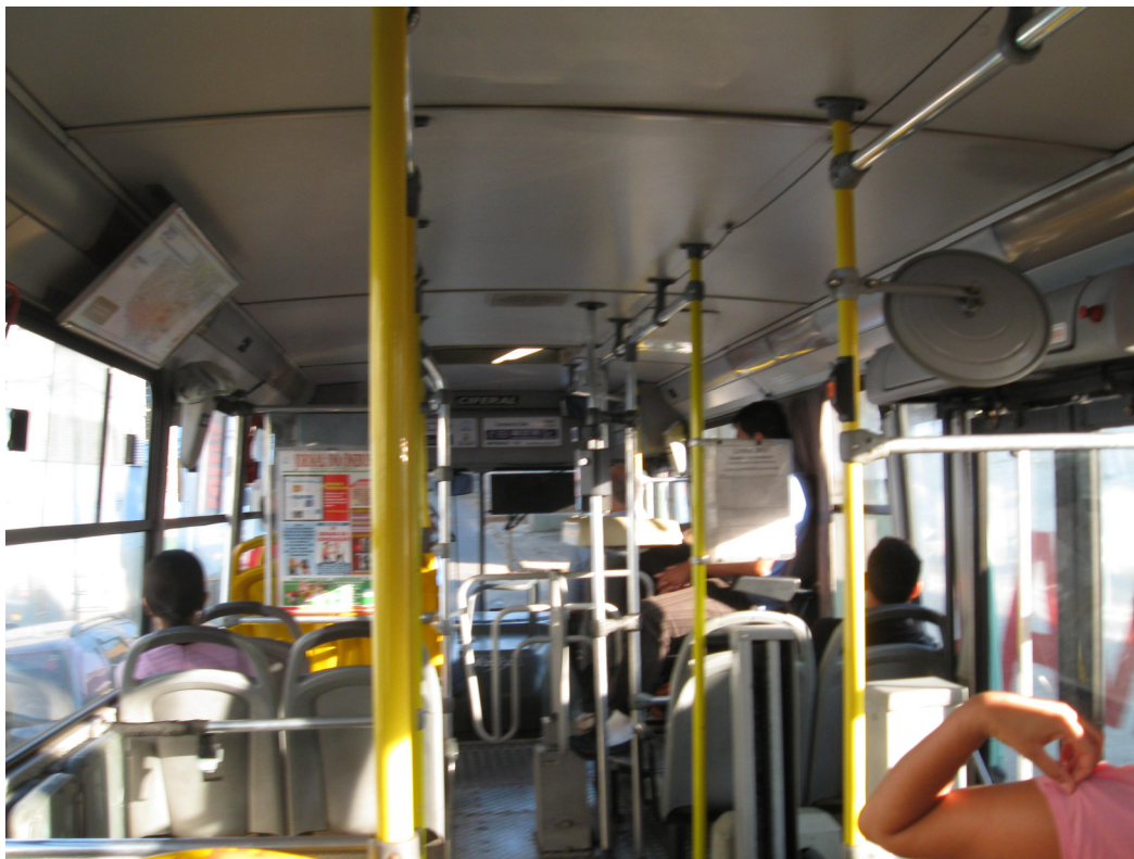
FIGURA 5 - Corredor de acesso e distribuição dos assentos FONTE: Arquivo do autor
