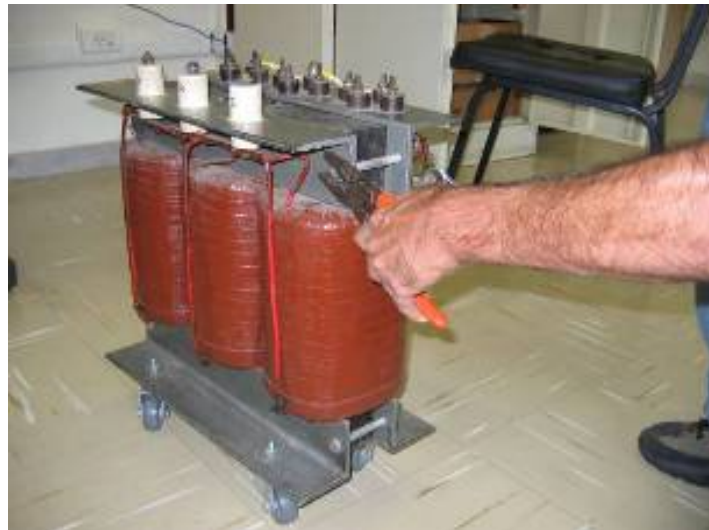
Figura 79: Processo de afastamento das placas do núcleo do transformador.
