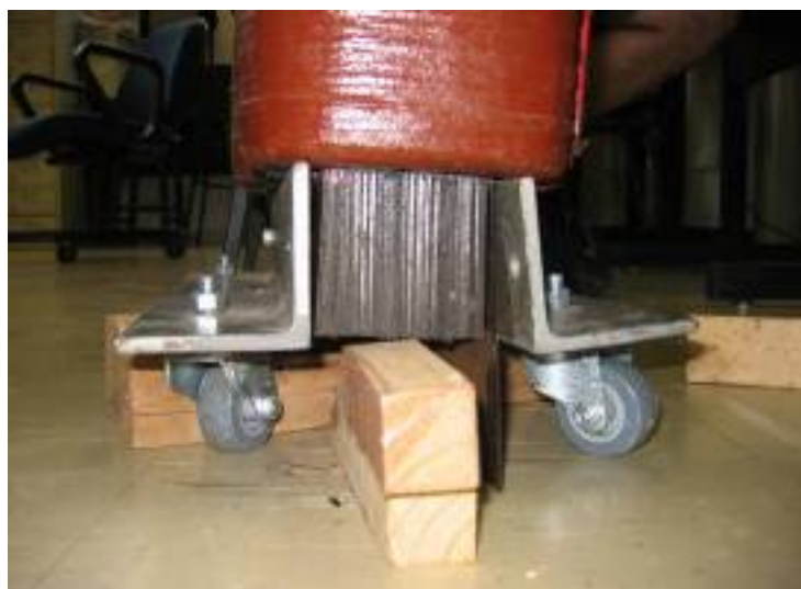
Figura 80: Detalhe das laminas do núcleo.
