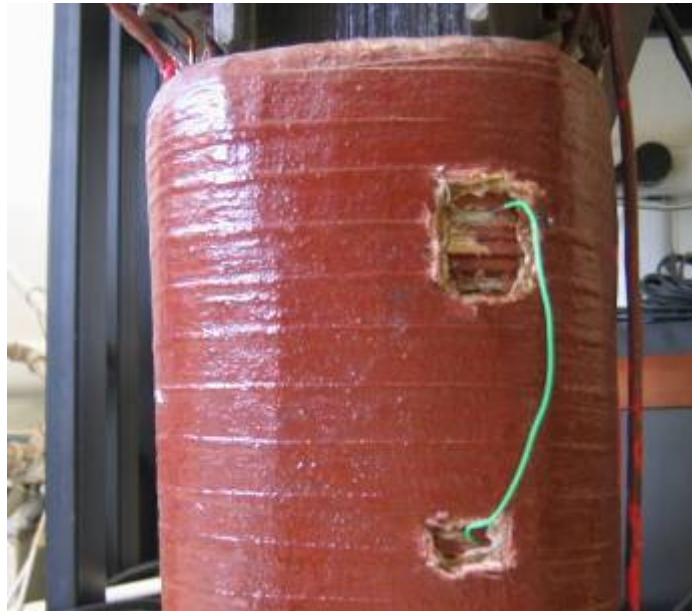
Figura 72: Curto-circuito entre várias espiras da bobina A.
