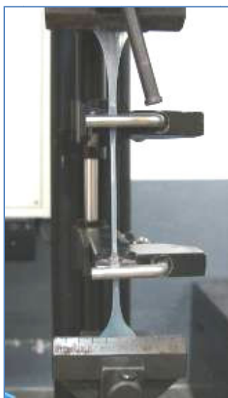
Figura 5.11: Fotografia tirada durante o ensaio de tração
