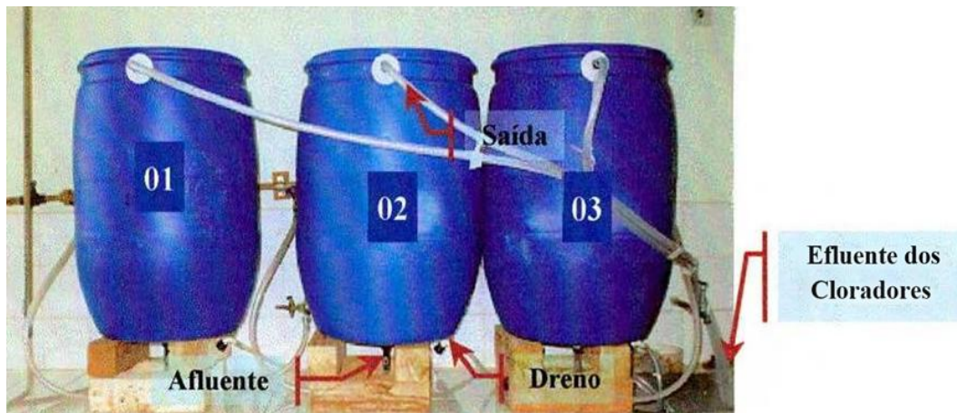
Figura 9 - Detalhe das bombonas como simuladores de poços
