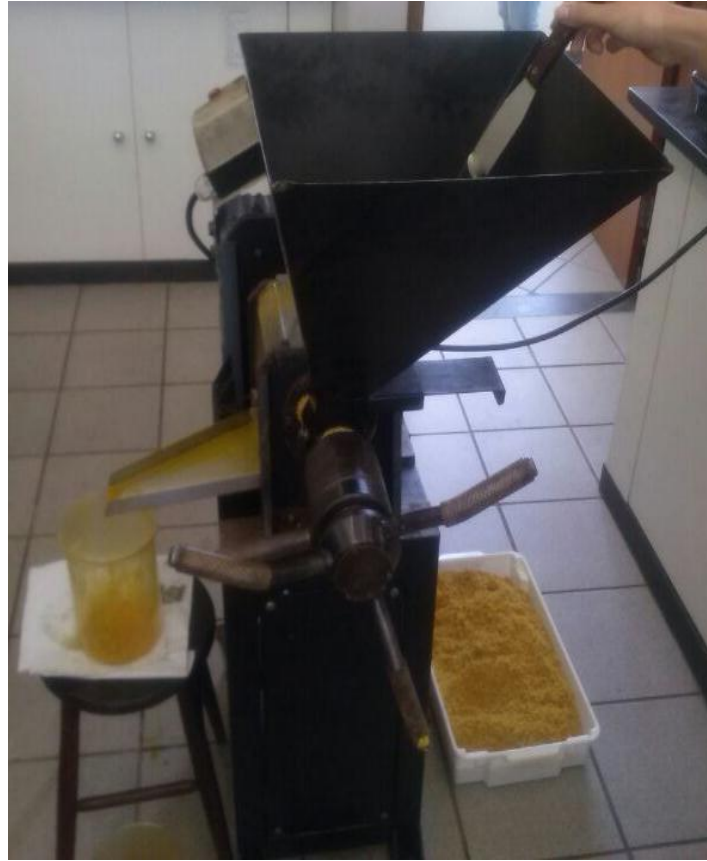
Figura 31: Prensa mecânica utilizada para a produção do óleo de baixa acidez.
