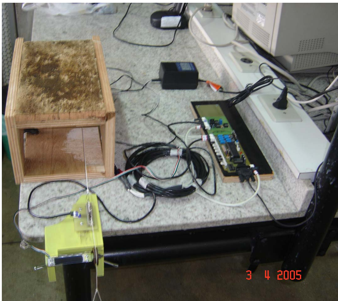
Figura 3: Foto do sistema montado pelos professores do Departamento de Engenharia Mecânica, que permitiu a realização do protocolo de alongamento.
