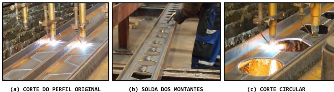
Figura 43 – Processo atípico de fabricação de vigas celulares adotado por Sonck (2013). Imagem adaptada de Sonck (2013).
