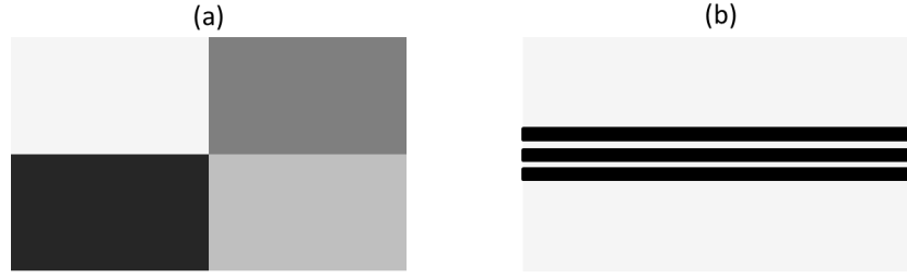
FIGURA 2.3: Exemplos de figuras que podem ser usadas nos SLMs: (a) dividindo o SLM em 4 modulações distintas; (b) para alguns tipos de SLMs não é necessário o uso de fendas físicas, sendo possível criá-las usando o SLM, como no exemplo dessa figura, que foi construída uma fenda tripla
