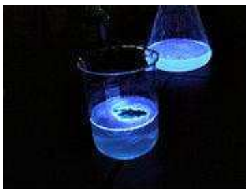
Figura 2.1: Luminol emitindo luz na presença de hemoglobina
