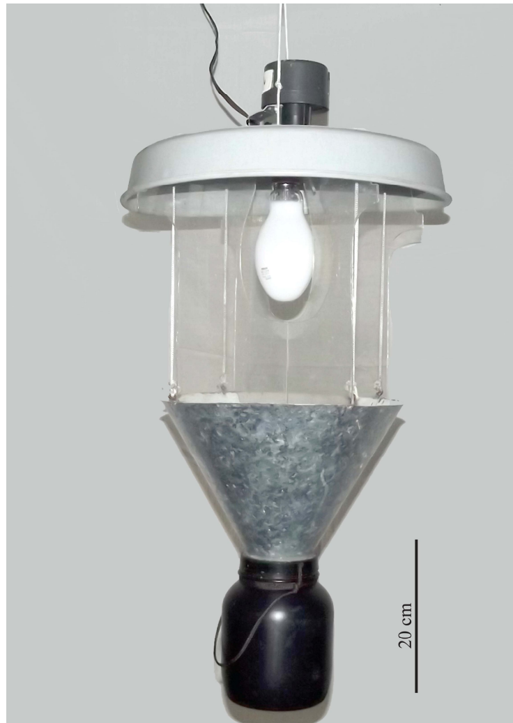
Figura 2 - Armadilha luminosa construída no Laboratório de Taxonomia de Ichneumonidae (UFMG), com base no modelo Luiz de Queiroz (Silveira Neto & Silveira, 1969).
