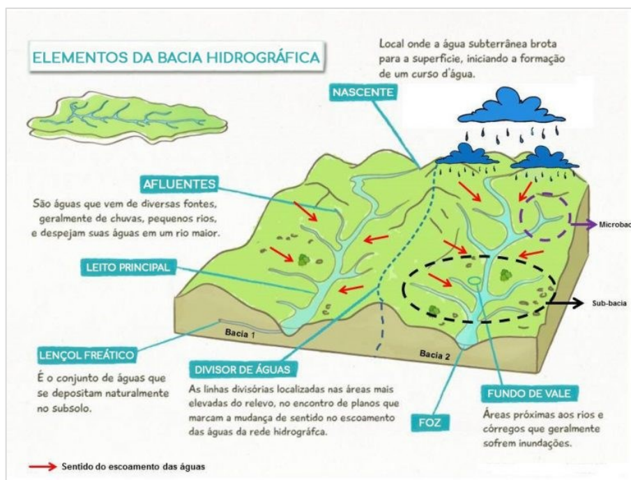
Figura 1.1- Esquema Representativo dos Constituintes de uma Bacia Hidrográfica
