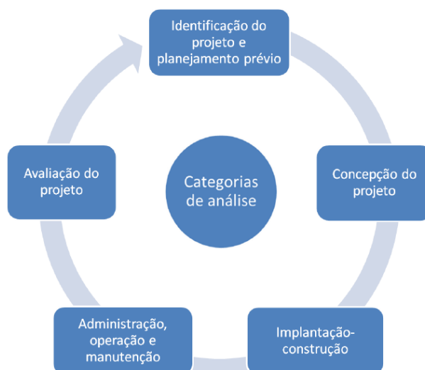
Figura 3.1: Ciclo de projeto de um sistema de saneamento para áreas rurais
