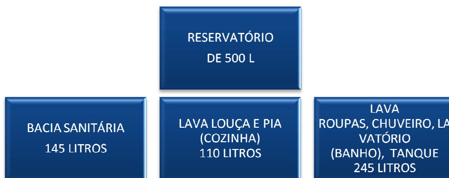
Figura 9: Distribuição de água de um reservatório residencial
