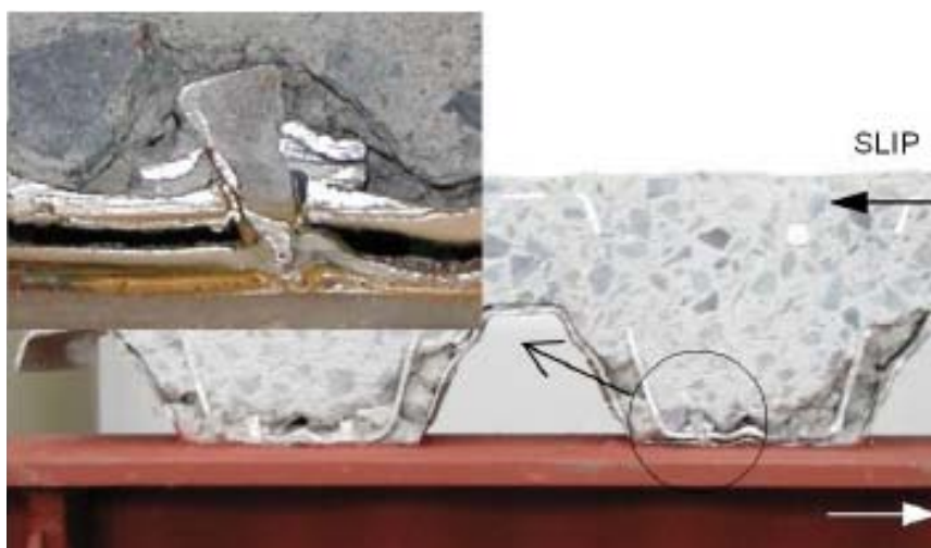
Figura 2.21 – Estado final dos conectores 17
