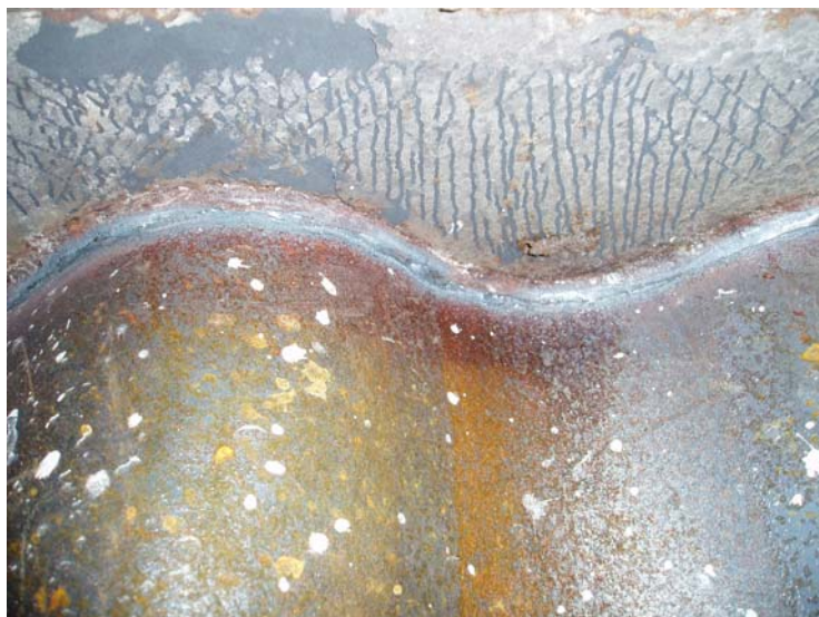
Figura 4.31 – Formação de linhas de Lüder na mesa comprimida
