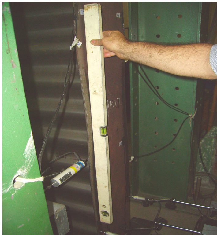
Figura 6.9 – Flambagem local da mesa – ensaio do protótipo 4B
