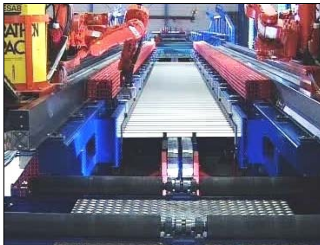
Figura 1.6 – Estação de montagem
