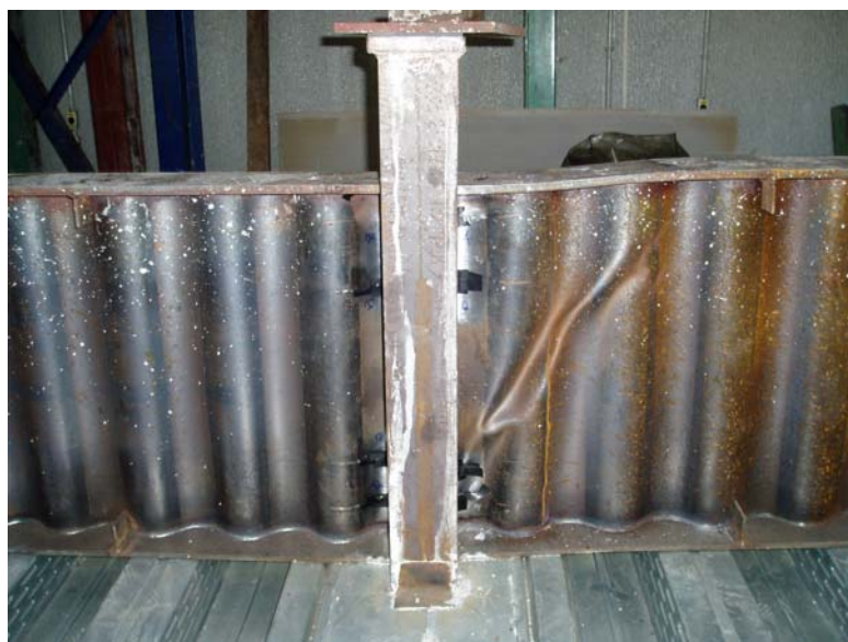
Figura 4.29 – Deformação da alma (‘‘campo de tração’’)
