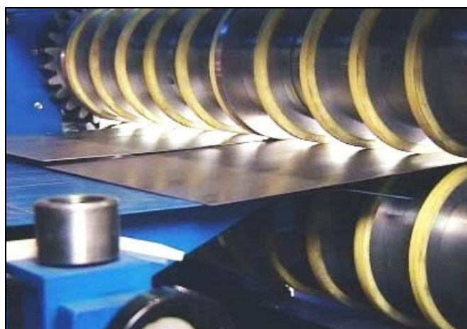
Figura 1.4 – Estação de corte
