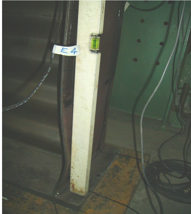
Figura 6.8 – Flambagem local da mesa – ensaio do protótipo 4A
