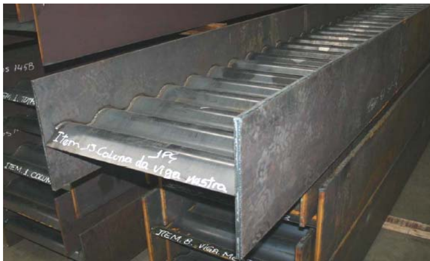
Figura 1.1 – Perfil de alma corrugada de geometria senoidal
