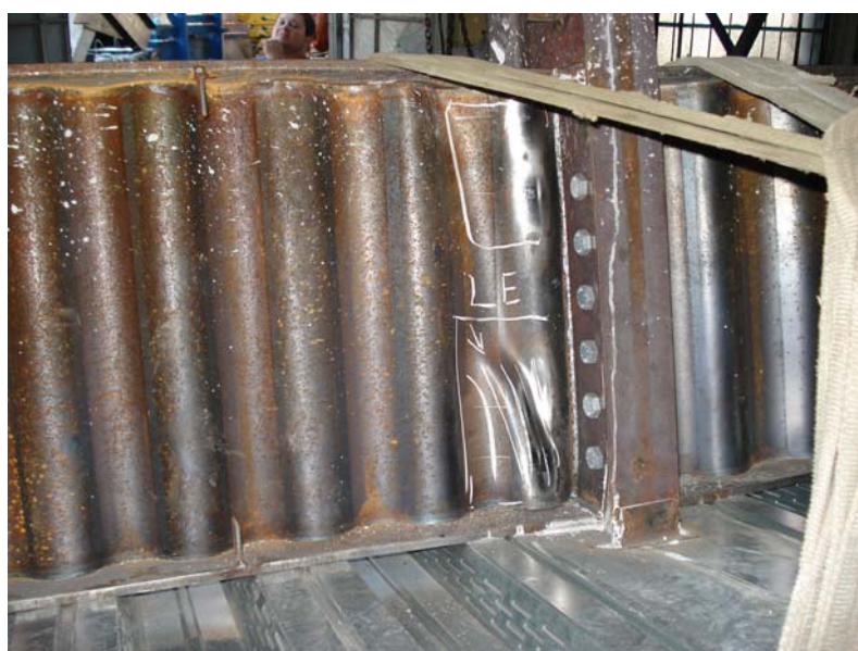
Figura 4.32 – Ruína do protótipo 1, com o início de formação do “campo de tração”
