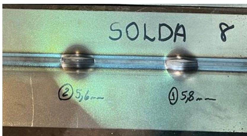
Figura 45- Aspecto de abertura de solda para amostra 8 submetida ao ensaio de embutimento. Fonte: elaboração própria
