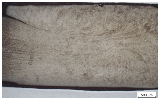
Figura 38 – Aspecto da microestrutura via microscopia óptica na superfície da junta em seção transversal da amostra 4. Nital 4%.
