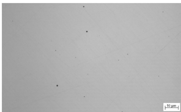
Figura 25 – Aspecto das inclusões observadas em amostra polida.
