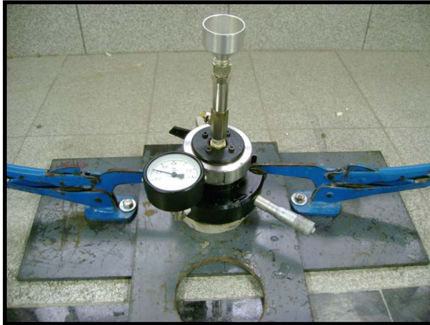
Fig 5.6. Permeabilímetro preso à pastilha por dois alicates de pressão
