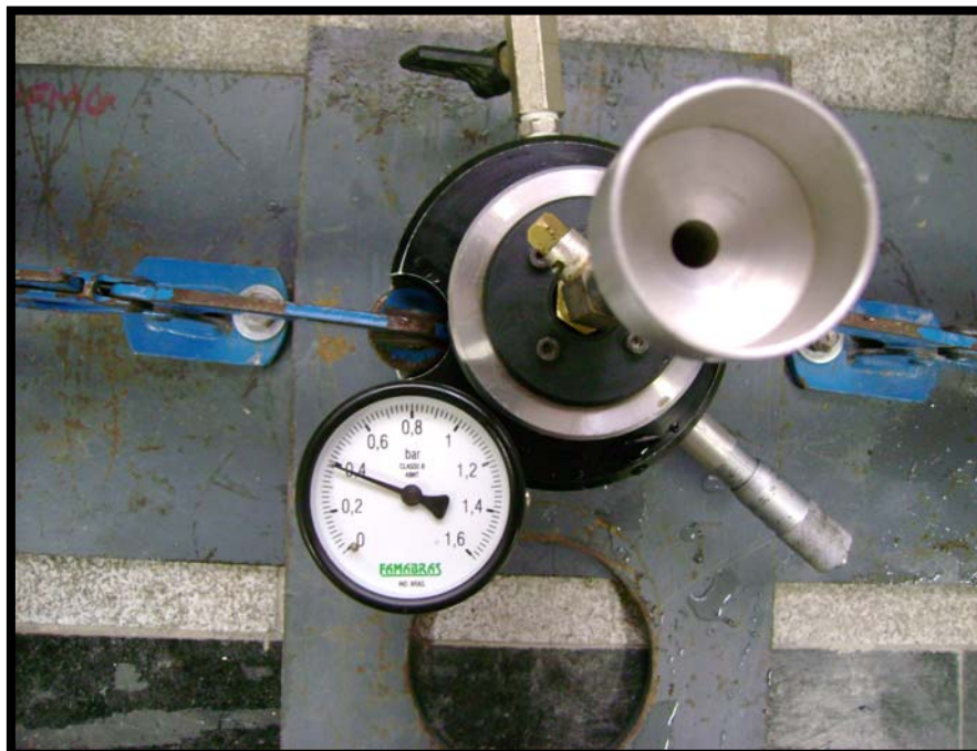
Fig 5.7. Pêndulo enroscado pronto para a água ser adicionada.
