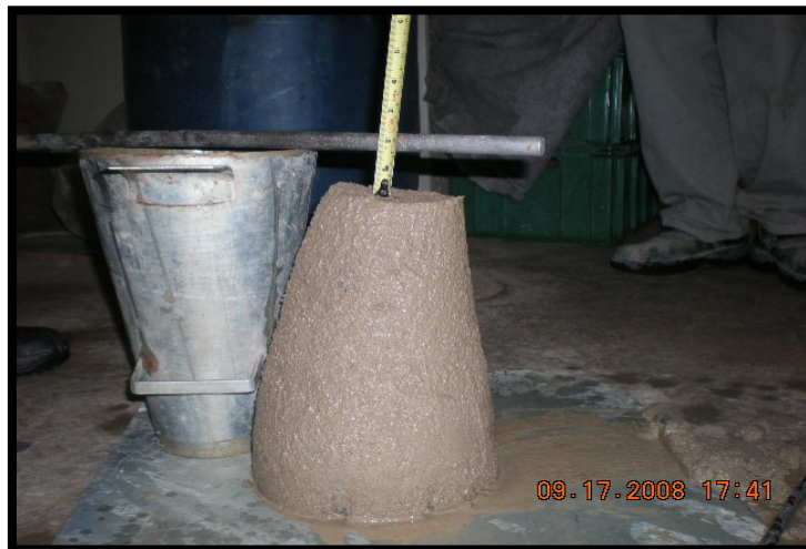
Fig. 5.4. Determinação da consistência pelo abatimento do tronco de cone. Fonte: CONSAG, 2008.
