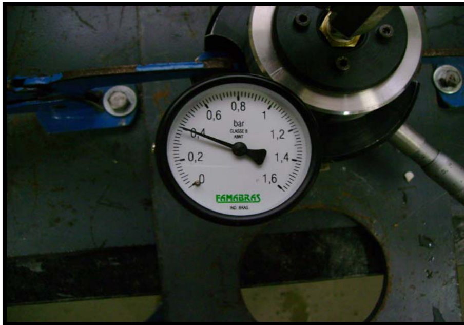
Fig 5.8. Manômetro indicando pressão no sistema igual a 0,4 Bar.
