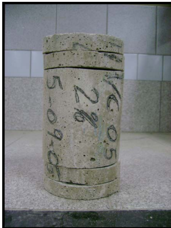
Fig. 5.5. Corpo de prova para determinação da permeabilidade.
