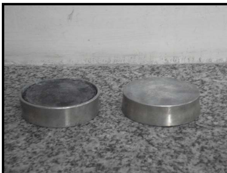
Fig 5.9. Disco de neoprene – Substitui capeamento com enxofre. Fonte: ALVES, 2008.
