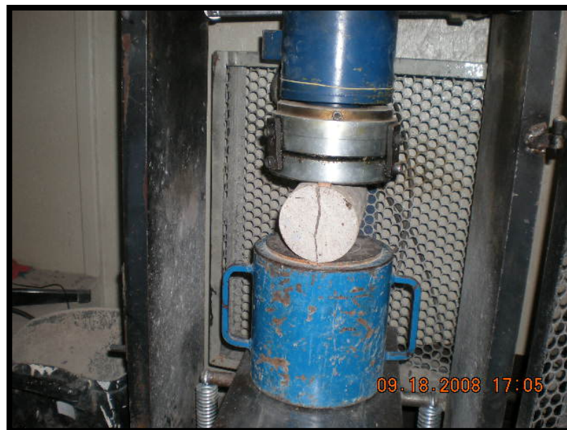
Fig 5.14. Corpo de prova rompido por tração diametral. Fonte: CONSAG, 2008.
