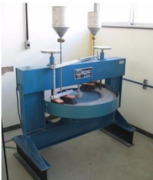
Figura 4.42 - Máquina para ensaio de desgaste tipo Amsler, do Laboratório de Rochas Ornamentais do CPMTC (Instituto de Geociências – UFMG).
