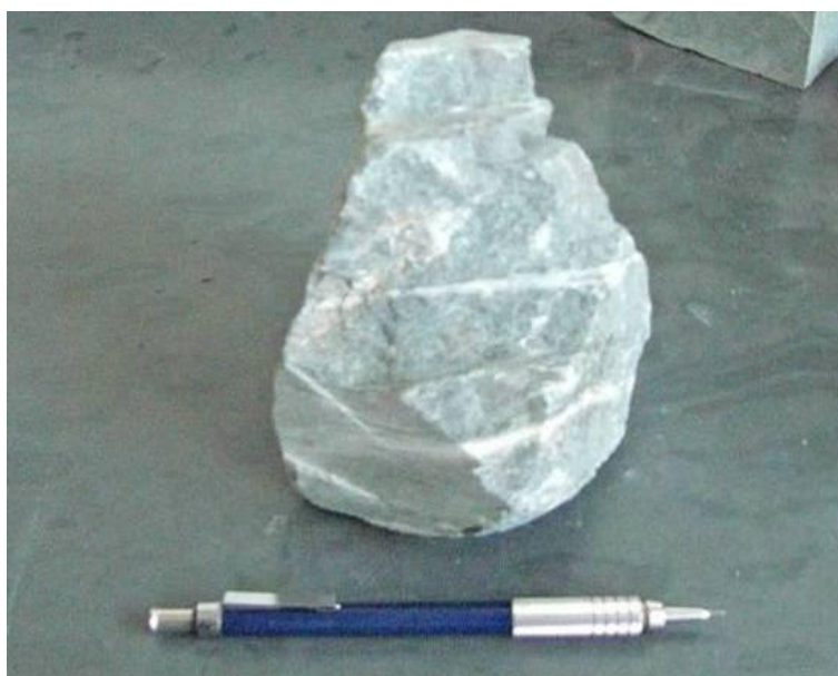
Figura 4.28 - Albita-carbonato-clorita-quartzo xisto: aspecto macroscópico onde podem ser observados os filmes de material carbonáticos. Amostra coletada entre as cidades de Caeté-MG e Sabará-MG.
