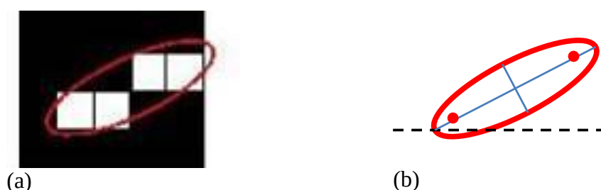
Figura 3.29 - Ilustração do sistema Matlab® dos eixos e orientação da elipse, com (a) os pixels do objeto representados em branco e sua elipse correspondente em vermelho e (b) a mesma elipse com feições representadas graficamente: linhas azuis são os eixos, pontos vermelhos são os focos e a orientação é o ângulo entre linha horizontal pontilhada e o eixo maior.
