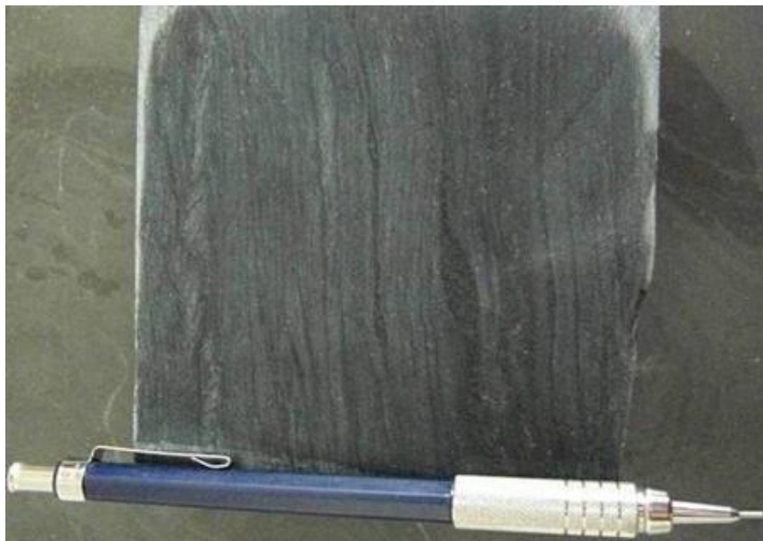
Figura 4.8- Granada-estaurolita-clorita-moscovita-quartzo xisto: aspecto macroscópico, onde se observa a presença de bandas mais claras alternadas a bandas escuras. A amostra foi molhada para melhor visualização das estruturas.
