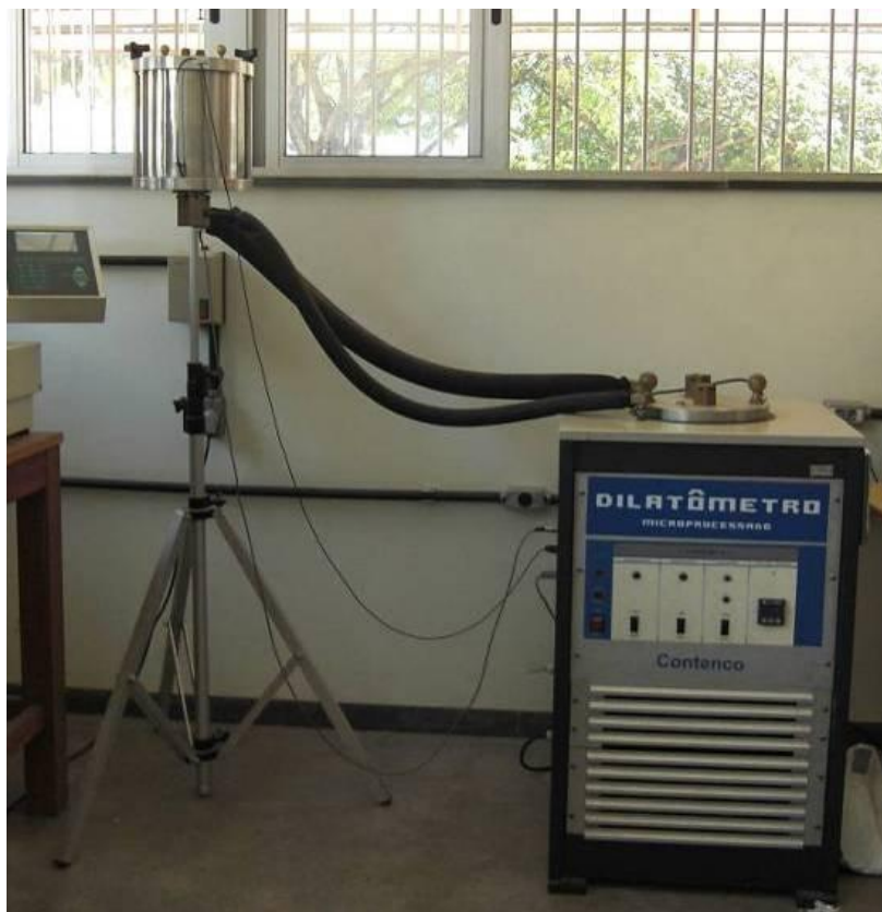
Figura 4.43 - Máquina para ensaio de dilatação térmica linear, do Laboratório de Rochas Ornamentais do CPMTC (Instituto de Geociências – UFMG).
