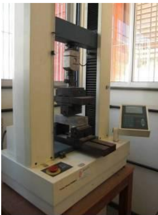
Figura 4.45 - Prensa hidráulica da empresa TINIUS OLSEN, modelo H25K-S para ensaios de resistência à flexão (LABTECRochas /CPMTC – IGC – UFMG).
