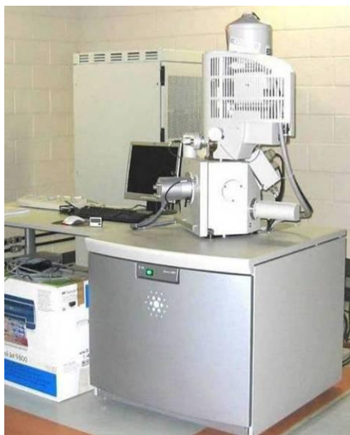
Figura 3.16 - Microscópio Eletrônico de Varredura com canhão de emissão por efeito de campo modelo Quanta 200 - FEG - FEI - 2006, do Centro de Microscopia da UFMG (Fonte: http://www.ufmg.br/microscopia/images/stories/images/quanta_200feg.jpg capturada em 2011-07-12).
