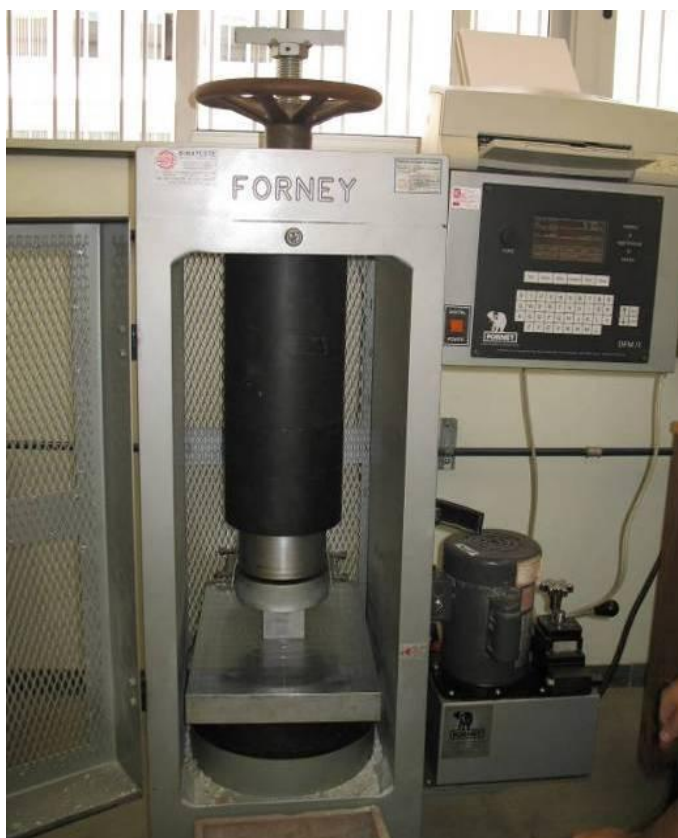
Figura 4.44 - Prensa hidráulica da empresa FORNEY, para ensaios de resistência à compressão (LABTECRochas /CPMTC – Instituto de Geociências – UFMG).
