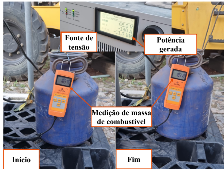
Figura 4.6 – Medições de massa de combustível e parâmetros elétricos durante o ensaio experimental de geração.
