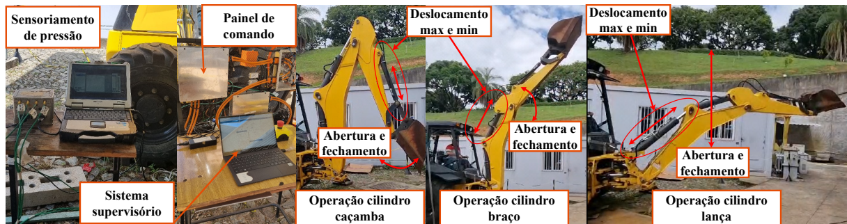
Figura 4.8 – Configuração do ensaio de acionamento do implemento traseiro para caracterizar a operação dos atuadores e do ciclo de operação com um sistema elétrico.
