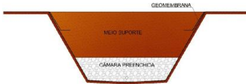
Figura 7 – Esquema da instalação das geomembranas para redução dos curto circuitos.
