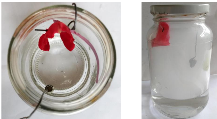
Figura 9.5 – Pétala antes (direita) e depois (esquerda) da combustão do enxofre.
