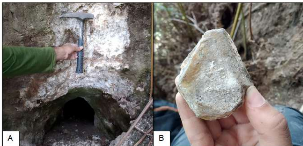
Figura 10 - (A) Túnel abandonado de garimpo para extração de muscovita; (B) Quartzo prismático encontrado no saprólito do gnaiss
