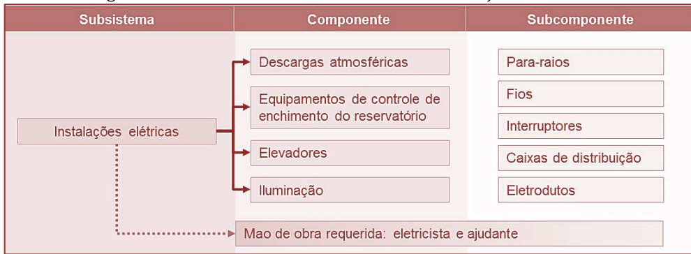
Figura 2 - Árvore relacional do subsistema instalação elétrica.
