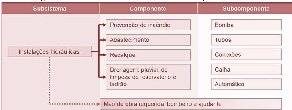
Figura 3 - Árvore relacional do subsistema instalação hidráulica.
