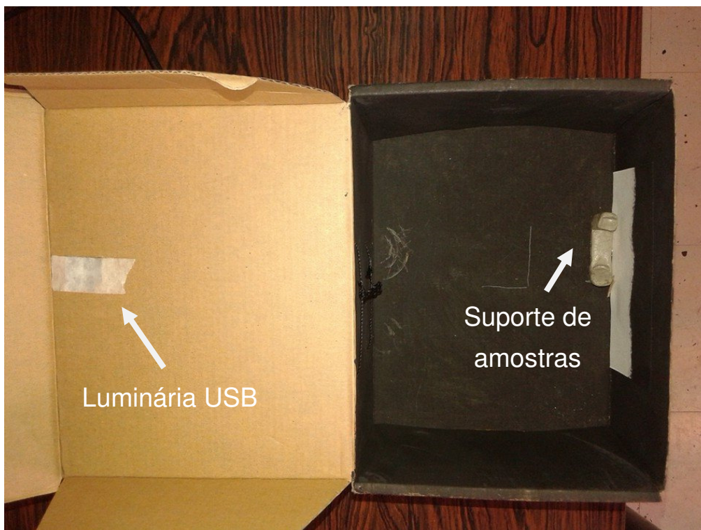
Figura 47 - Câmara de aquisição de imagens (vista superior aberta)
