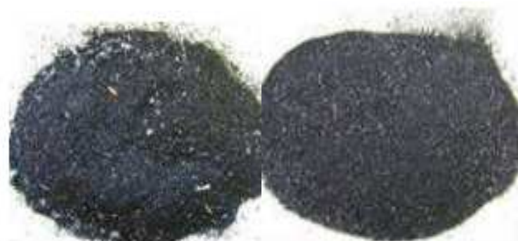
Figura 1 - Cinza da casca de arroz - a) sem beneficiamento , b)material passante na peneira #1.2mm 2 Fonte: KRUG, 2011
