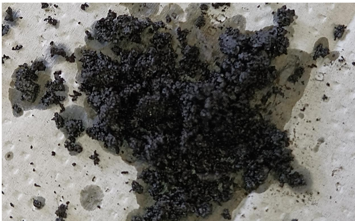
Figura 19. Produto de repolimerização do bio-óleo de eucaliptos destilado na presença do suporte de NbOPO 4 .
