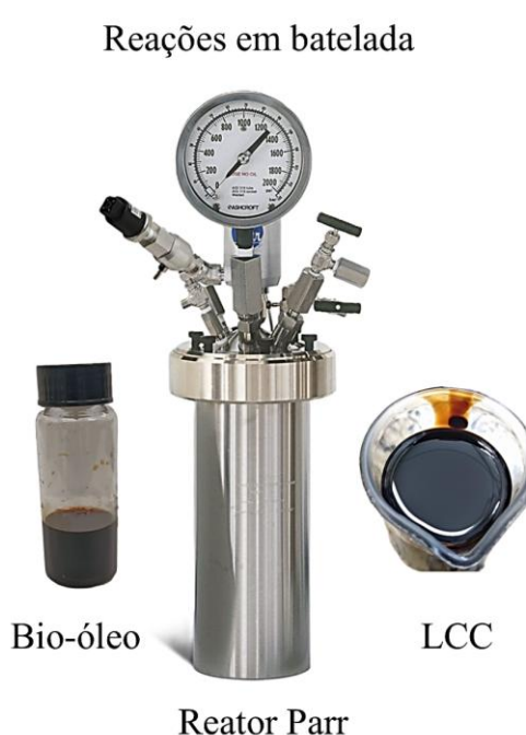
Figura 7. Esquema das reações realizadas nos testes catalíticos de desoxigenação do bio-óleo e do líquido da casca da castanha-de-caju
