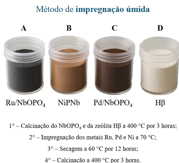
Figura 6. Esquema de preparo e caracterização dos catalisadores usados nas reações de desoxigenação do bio-óleo e do líquido da casca da castanha-de-caju.
