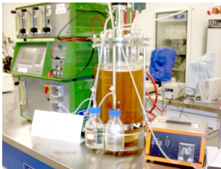
Figura 4 - Biorreator B. Braun® utilizado para produção da toxina botulínica de C. botulinum tipo D.
