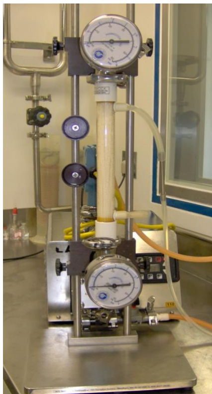
Figura 5 - Sistema Hollow Fiber , de filtração tangencial, montado com cartucho Hollow Fiber UFP-30-E-5A e bomba de lóbulos Teknoflow Unibloc PD.
