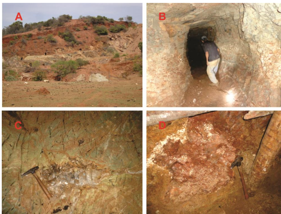
Figura 4. Prancha apresentando, A. Visão geral da área do Campo do Boa, com diversas galerias de garimpagem em plena operação. B. Visão de detalhe de um desses túneis (“Serviço do Vilmar”). C. Rocha metabásica alterada com “lente” de quartzo e feldspato alterado, mostrando crescimento de epidoto nas bordas. D. “Bucho” de quartzo mal cristalizado e feldspato alterado, considerado guia para a detecção da mineralização.
