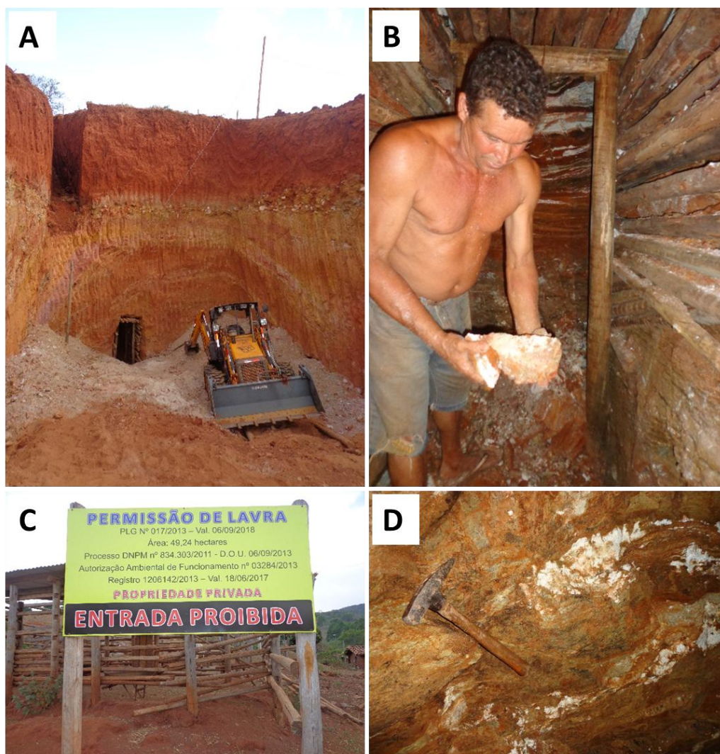
Figura 12 - Prancha apresentando fotografias do trabalho de campo realizado em outubro de 2015 no depósito do Fanadinho II. “A” (entrada do túnel de garimpo que fica na parte de fora do sítio do Adão), “B” (Adão mostrando fragmento de feldspato fortemente intemperizado), “C” (placa na entrada do sítio do Adão com permissão de lavra concedida pelo DNPM) e “D” (veio de feldspato intemperizado – porção branca na parede do túnel de garimpo que é usada como guia para mineralização de titanita).
