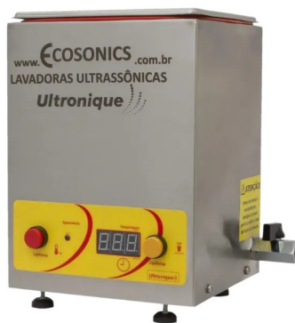
Figura 26 – Ultrassom utilizado no processo de limpeza.
