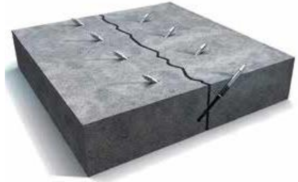
Figuras 6.1 e 6.2: Perfuração a 45° da superfície do substrato, MC Bauchemie.
