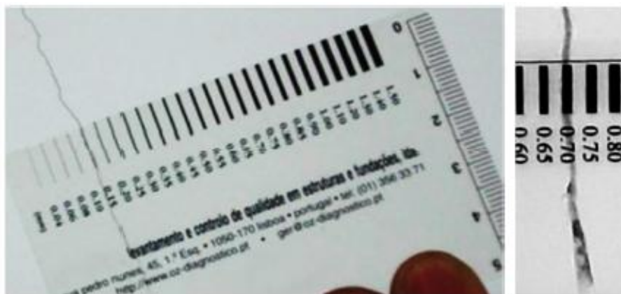
Figura 5.4: Comparador de fissuras, Google/Imagens.
