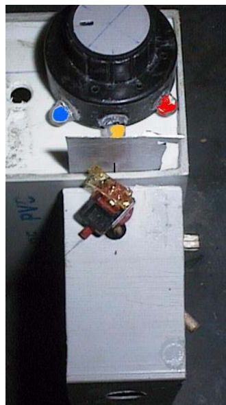
Fig. 5.22 – Goniômetro de Foucault. Montagem para medidas de n_D , n_F e n_C , utilizando led's.
