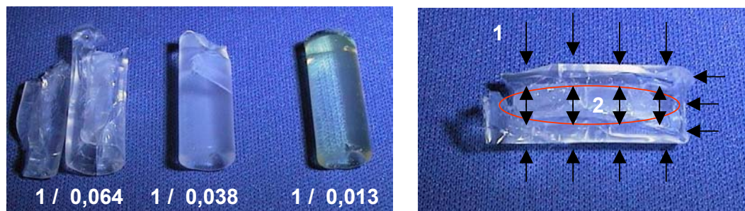
Fig. 5.13 – Influência da razão molar TEOS/formamida na transparência. 1) Sentido do fluxo de calor e 2) sentido do transporte da porosidade.
