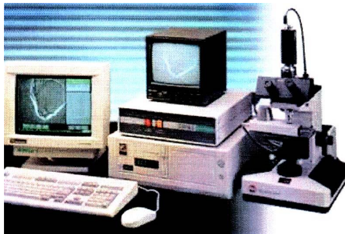
Fig. 3.26 - Aparelho para medida de n pela variação da temperatura do óleo de imersão.
