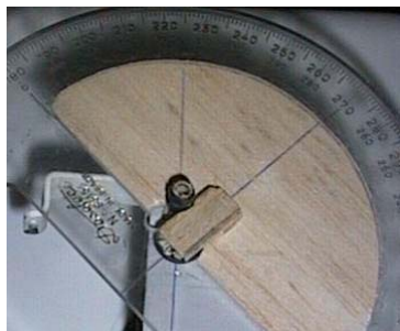
Fig. 5.21 – Goniômetro de Foucault. Montagem para medidas de n_D .
