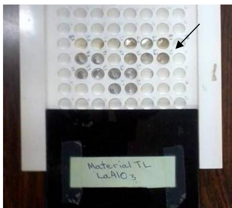
Figura 3.6 Porta-amostras de PVC, com tampa de acrílico (PMMA), a seta em preto indica um cadinho de alumínio acomodado em sua posição de irradiação.
