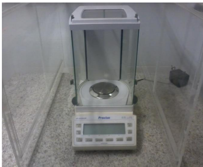
Figura 3.3 - Balança de precisão, marca Precisa – XR 25S. Utilizada para pesagem das amostras.
