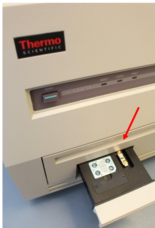
Figura 3.8 - Leitora TL Harshaw TLD-4500. A seta indica a placa de aquecimento onde a amostra é posicionada.
