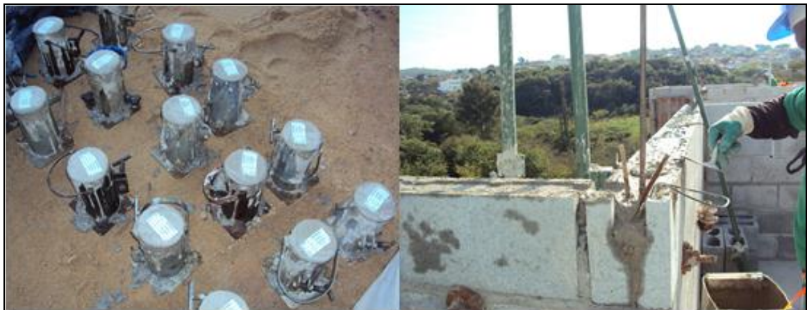
Figura 16: Corpo de prova de graute utilizado em obra
