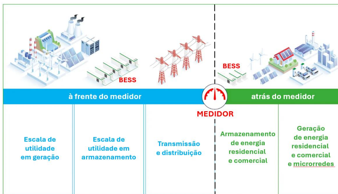
Figura 15 – Tipos de instalação de BESS.
